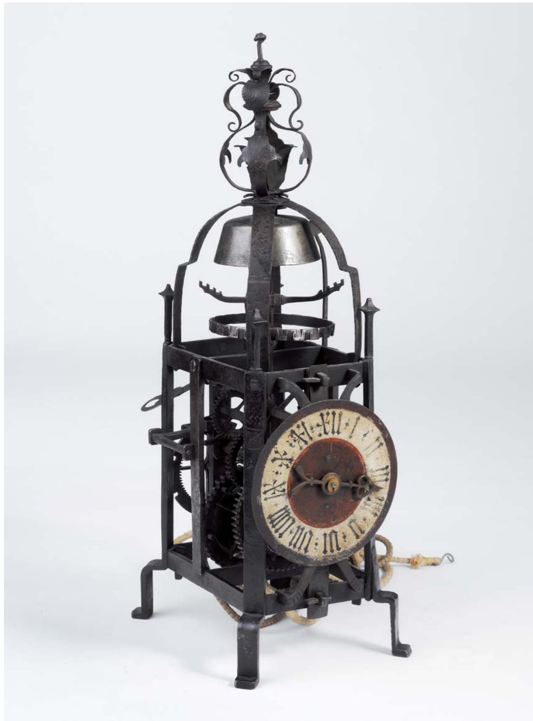
Räderuhr, Tirol, bez. 1555, Schmiedeeisen, Zeiger und Schlagwerk zum Anzeigen der vollen Stunden. TVKM, Inv. Nr. 32222.
